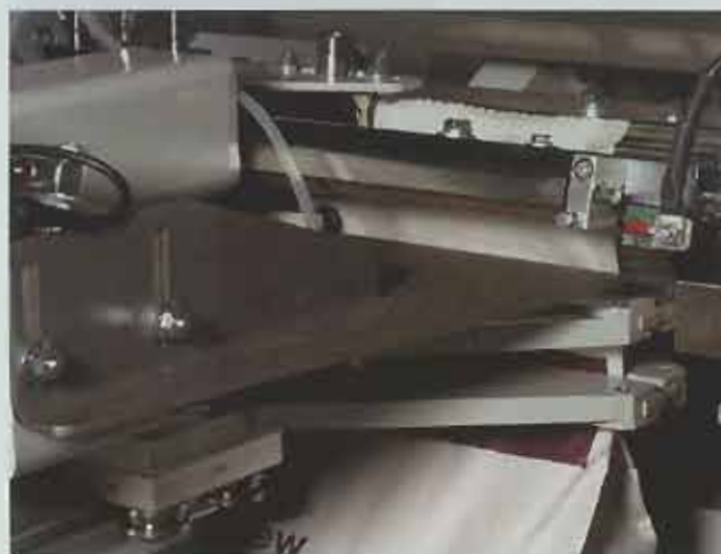
Sealing of the PE inliner
